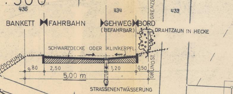
REGELQUERSCHNITT DER PLANSTRASSE (A) M. 1:500
